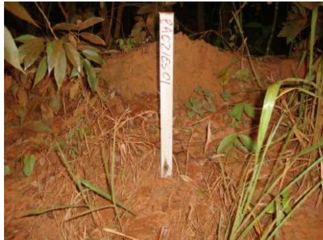
Figura 7.1 – Exemplo de locação topográfica utilizada nos projetos hidroambientais da bacia do Rio São Francisco
